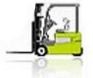
As cargas são carregadas em garfos, com movimentos para cima e para baixo, sobre um quadro situado na parte dianteira do veículo. As rodas traseiras são Direcionais e as dianteiras são de Tração.
